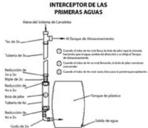
Figura 4.14. Interceptor de primeras aguas
